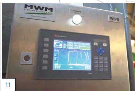
Фот. 11 – Вид экрана системы мониторинга вибраций
