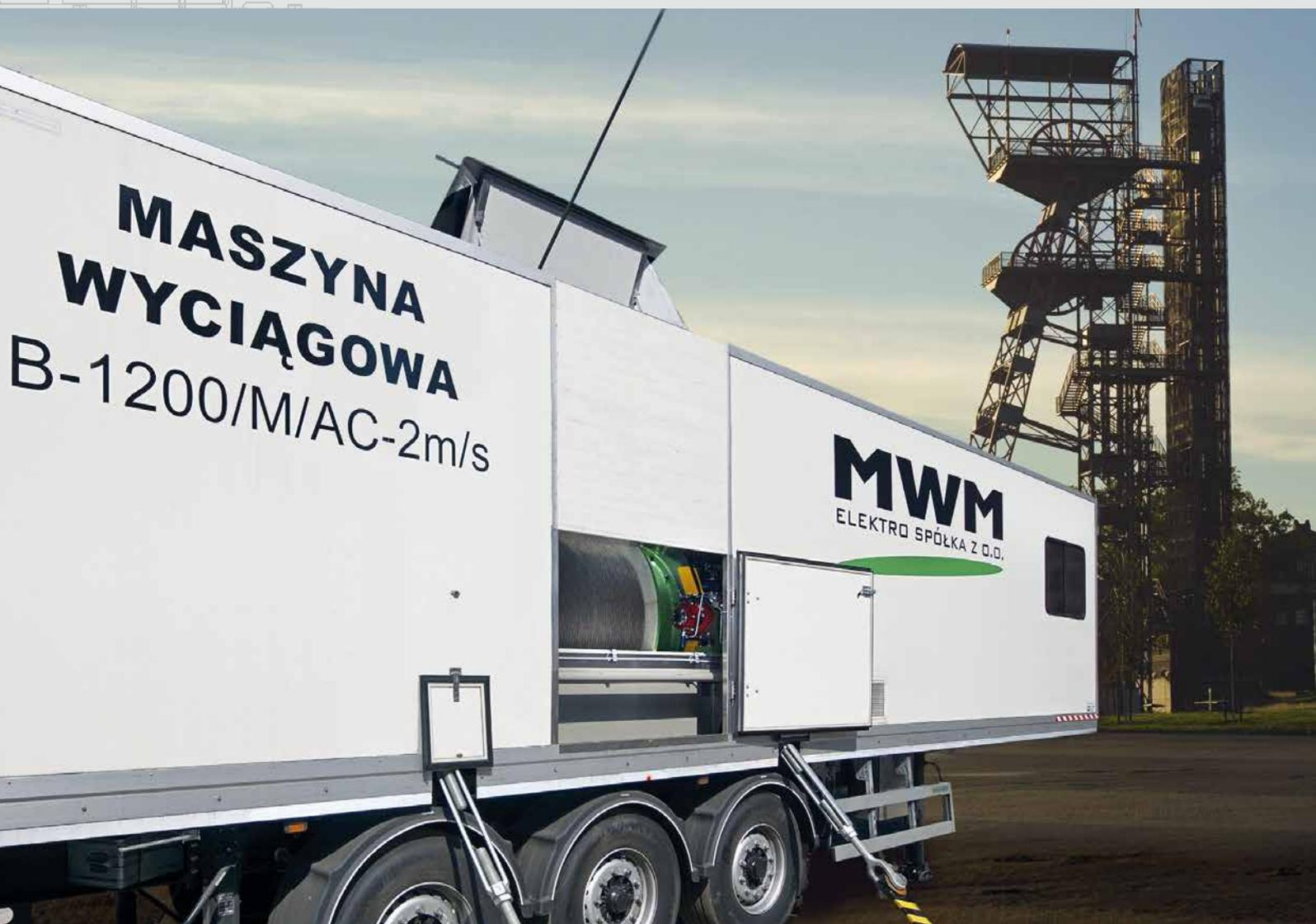
Мобильная подъёмная машина – привод шахтной подъёмной установки, с дополнительным оборудованием как комплексная подъёмная установка.
